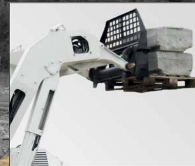
Avant : couplage rapide hydraulique (250 litres/minute sous 400 bar) et connexion électrique (CAN bus et alimentation)
