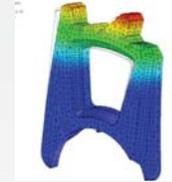
Testé avec des mines antichars de 8 kg de TNT. Ni les éclats, ni le souffle ne font plier l'axe.
