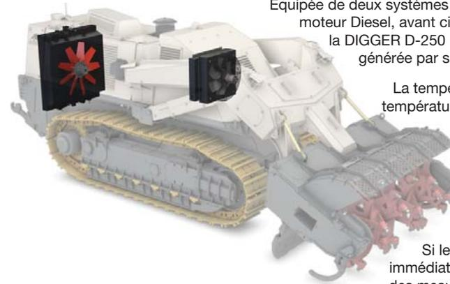
La température ambiante, la température du moteur Diesel et celle du circuit hydraulique sont en permanence surveillées par le système électronique. Celui-ci prendra les mesures adéquates pour s'adapter.
