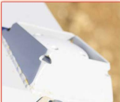
Les antennes GPS (2) sont totalement intégrées dans la machine et préviennent ainsi des risques d'accrochage avec de la végétation.
