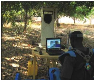
Le système caméras de DIGGER DTR s'intègre parfaitement à la machine. Il fusionne les données de la télécommande et les informations en provenance de la machine distante. Le pilote, d'un seul coup d'œil, a une vue globale de son travail.
