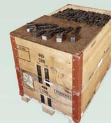
Pour fléau de déminage. Contient : masselottes avec chaînes ainsi que vis et écrous de fixation.
