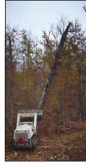
Travailler dans un milieu de végétation dense peut s'avérer très délicat pour une machine. En effet, le moindre élément fragile est à coup sûr arraché. La DIGGER D-250 a été conçue pour qu'aucun élément vulnérable, tel qu'un tuyau hydraulique, ne soit accessible et visible de l'extérieur.
