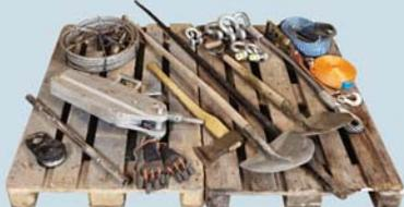
Outils sélectionnés pour l'aide à l'extraction manuelle de la machine en cas d'enlèvement.
