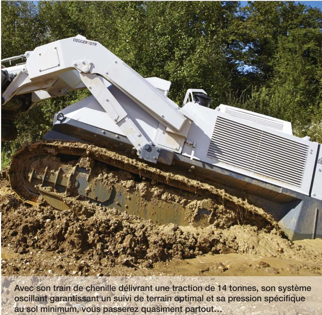
Avec son train de chenille délivrant une traction de 14 tonnes, son système oscillant garantissant un suivi de terrain optimal et sa pression spécifique au sol minimum, vous passerez quasiment partout...
