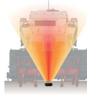
Par sa conception, la fraise de déminage « Twin-Pikes » offre une structure très aérée et réduit considérablement l'effet de confinement. Ceci permet aux gaz provoqués par l'explosion de s'évacuer en générant un minimum de contraintes sur la fraise et sur la machine.
