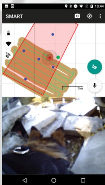
Sur le smartphone, le maître surveille la carte, la vidéo et les statistiques importantes en temps réel. L'émetteur Wi-Fi intégré permet l'échange des données entre le harnais et un smartphone.
